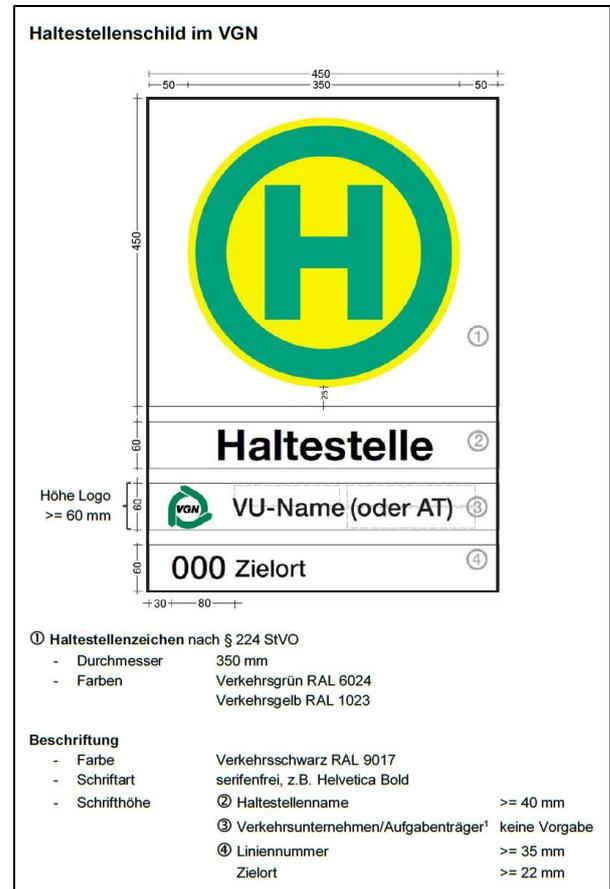
Abb. 39: Aufbau eines Haltestellenschildes nach VGN-Standard
