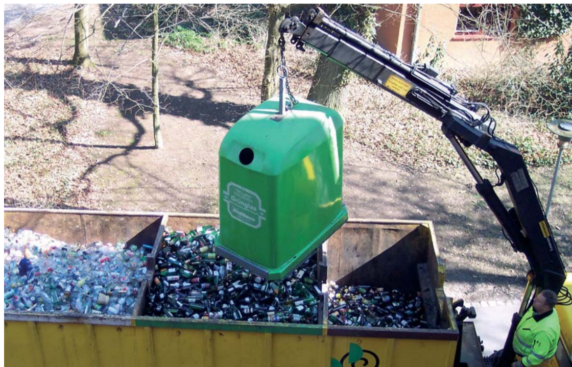
Auch bei der Umleerung in das Containerfahrzeug sind drei Kammern für die einzelnen Glasfarben vorhanden
